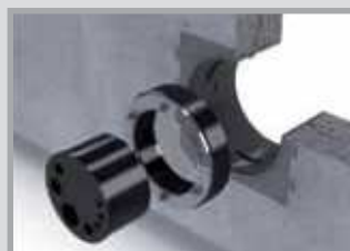
BKD 150 Bajonett-Systemeinsatz mit Wechseleinsatz Der Bajonett-Systemeinsatz kann ungeachtet der späteren Belegung montiert werden. Je nach Kabel- oder Rohrbelegung wird ein entsprechender Wechseleinsatz genutzt. Eine Änderung der Belegung ist durch Austausch des Wechseleinsatzes jederzeit möglich.
