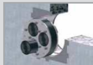
BKD 150 Bajonett-Systemeinsatz mit Zwiebelchnitt Mit dem Bajonett-Systemeinsatz BKD 150-ZS/3x(22-54) lassen sich bis zu drei Kabel oder Rohre mit den Durchmessern 22 bis 54 mm sicher abdichten. Die Zwiebel-schnitte können stufenlos an die Kabeldurchmesser angepasst werden.
